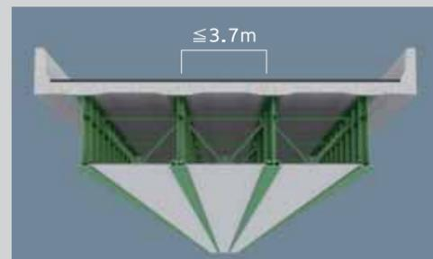
桁下にキュウサを設置できない場合で桁間に設置する形式。パネル受け部(アルミ受材)が無い構造形式です。
