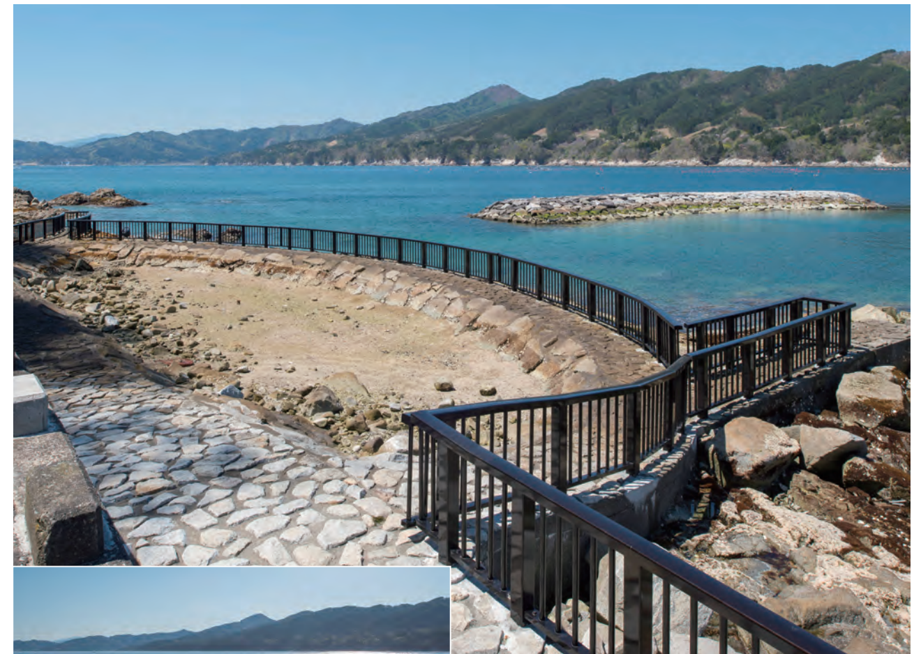
船越漁港しもかわ公園／岩手県 種別:ハイデンション型高欄(耐波浪型) タイプ:アルミ合金製 工事:新設
